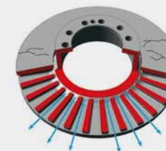
Si des fissures apparaissent, elles se propageront sur toute la surface du disque.
